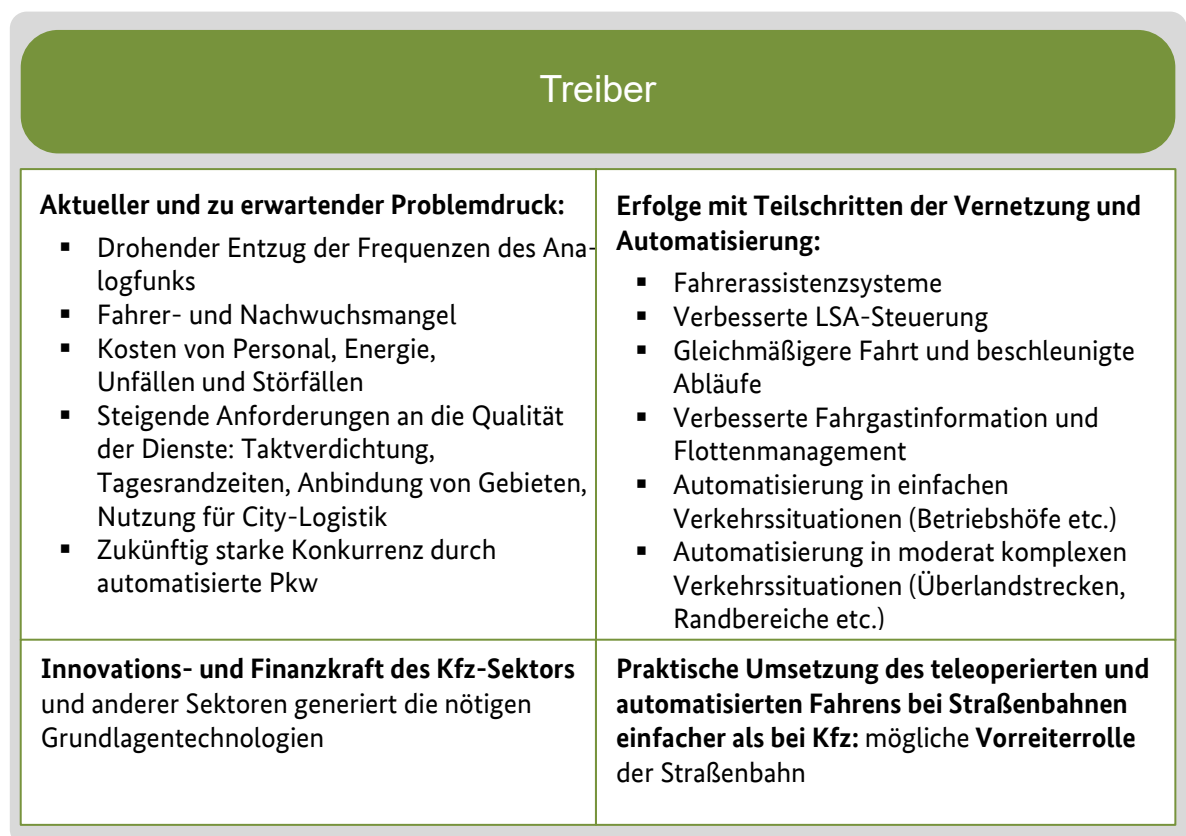
Abbildung 6-3: Treiber der Entwicklung der Automatisierung und Vernetzung von Straßenbahnen
